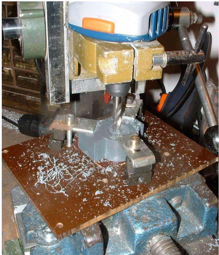
Auf diese Weise ist sowohl das 20mm Loch für die Hülse, als auch der halbrunde Bogen an der Vorderseite entstanden, der genau parallel zum Umfang des inneren Loches verläuft. Natürlich lässt sich diese Arbeit auch von der Maschine erledigen – würde ich beim nächsten mal wohl auch machen.
