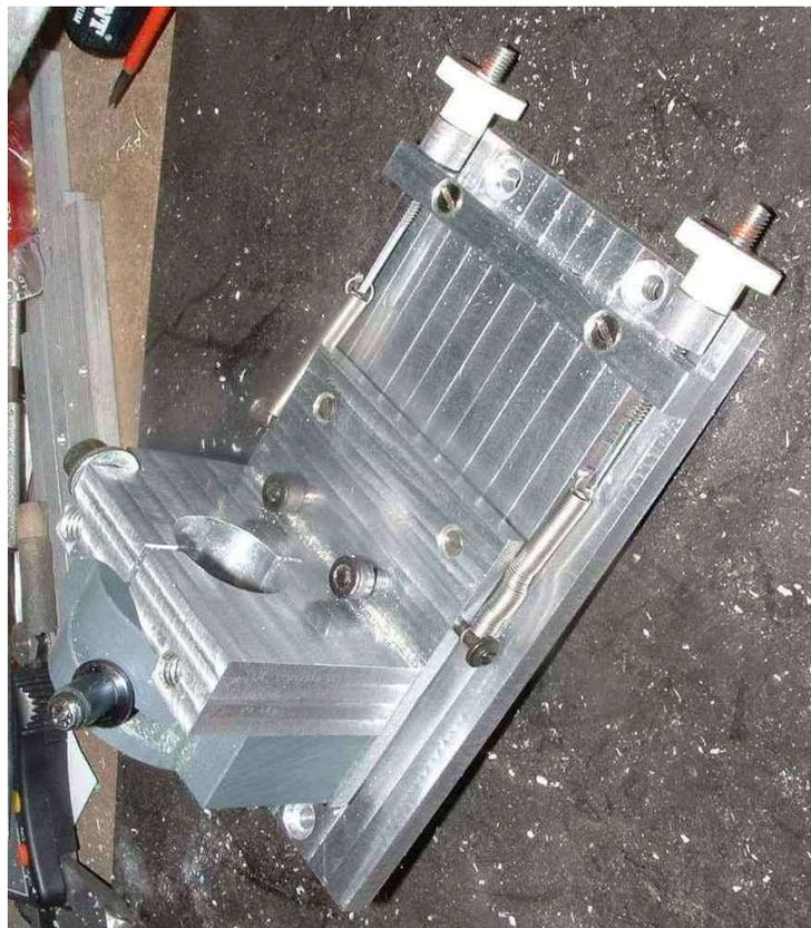
Auf dem folgenden Bild sieht man detailliert diese Konstruktion. Die kleine Aluhülse unterhalb der Rändelmutter ist lediglich als Abstandshalter eben dafür nötig, da ich den Aluhalter nicht nah genug an die Oberkante der Basisplatte schrauben konnte, da sonst die Befestigungslöcher verdeckt worden wären
