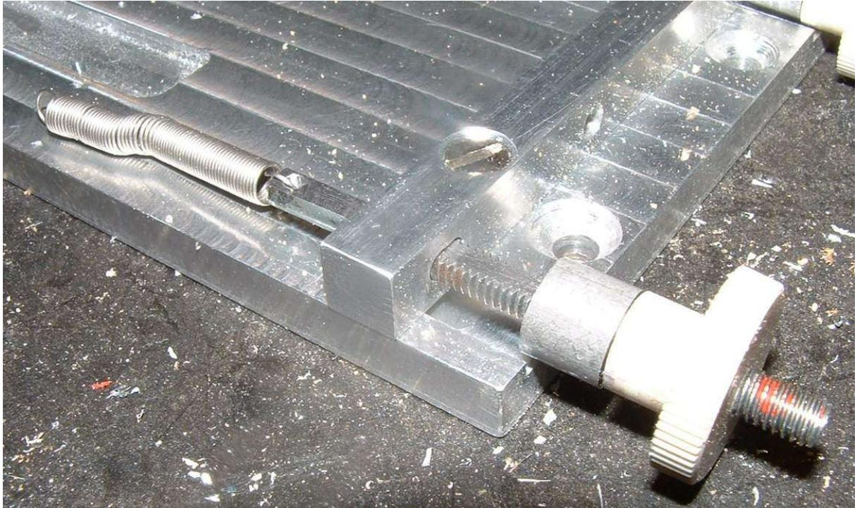
Nachdem für die Federn im beweglichen Maschinenhalter an beiden Seiten je ein kleiner Gewindebolzen zur Befestigung angebracht wurde, sieht der fertige Tiefenregler nun folgendermaßen aus:
