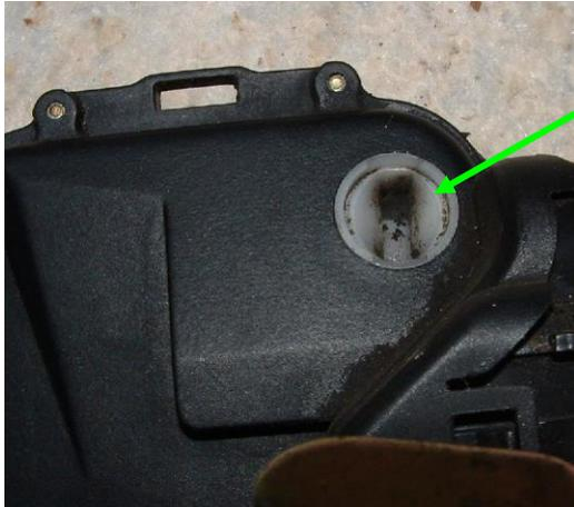
In diese auf der Rückseite des Schlosses befindliche Buchse muss der Zapfen exakt eingreifen.
