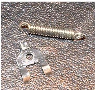
Ich stellte ziemlich schnell fest, dass die Kontakte korrodiert waren, daher nahm ich die Kontaktfahne mit der Feder heraus, um die mit feinem Schmirgelstäbchen zu reinigen. ACHTUNG – ich empfehle jedem in diesem Stadium erst mal mit Kontaktspray zu arbeiten und loses Schmirgelpapier zum Anschleifen zu nutzen. Evtl. erspart das den Ausbau der Kontaktfahne und vor allem den überaus fummeligen Wiedereinbau.
